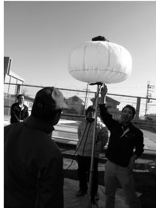
LED バルーン投光機 非常時の明かり確保に威力。
